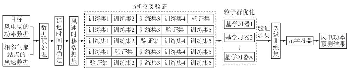
图 5 基于空间相关性与 Stacking 集成学习的预测模型训练过程
