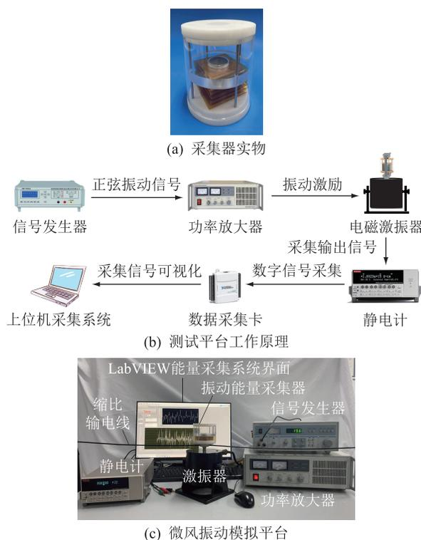
图2 测试平台工作原理、振动能量采集器实物和振动模拟平台
