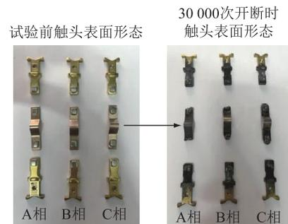
图 9 30 000 次开断时的三相主触头表面形态
