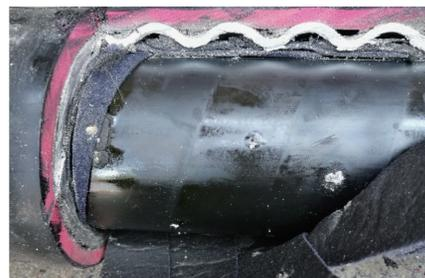
图 5 缓冲层与绝缘屏蔽层上的阻水粉分布
