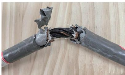
图9 电缆绝缘屏蔽层破损示意
