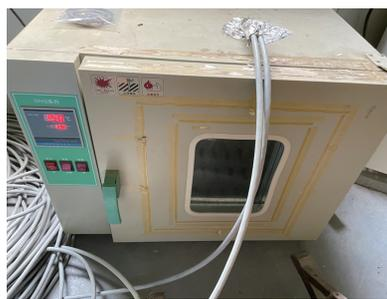
图 13 电缆的局部加速热老化实验示意
