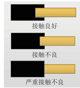
图 2 GIS 隔离开关不同接触状态
