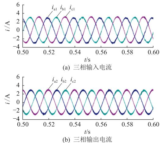
图 7 三相输入和输出电流
