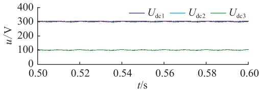
图9 子模块电压
