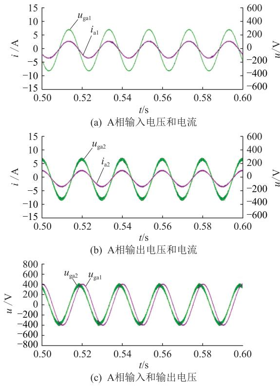
图8 A相电压和电流
