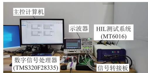
图9 HIL测试平台示意
