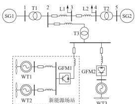
图 1 含构网型新能源的电力系统
