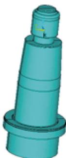
图 3 电缆终端 ANSYS 模型
