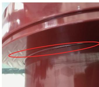
图 1 环氧套管裂纹局部
