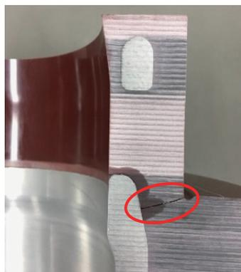
图 2 裂纹起源处的贯穿性裂纹
