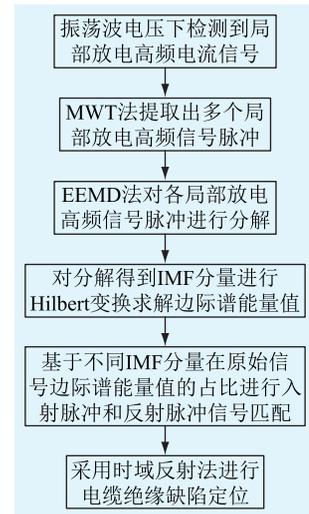
图 2 局部放电定位算法流程
