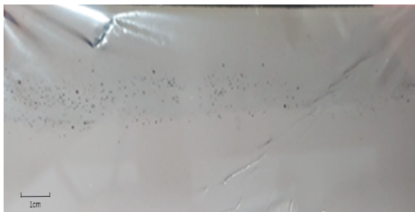
图 12 交流样品外层腐蚀情况
