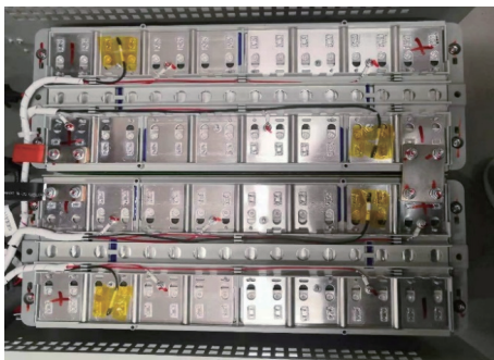
图 1 磷酸铁锂电池模组
