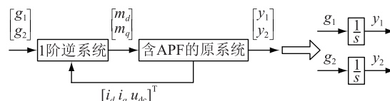
图 2 逆系统方法解耦线性化过程
