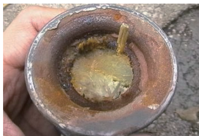
图2 断口金具密封胶残留情况
