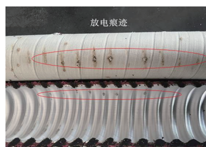
(a) 铜丝编织布及铝护套放电痕迹
