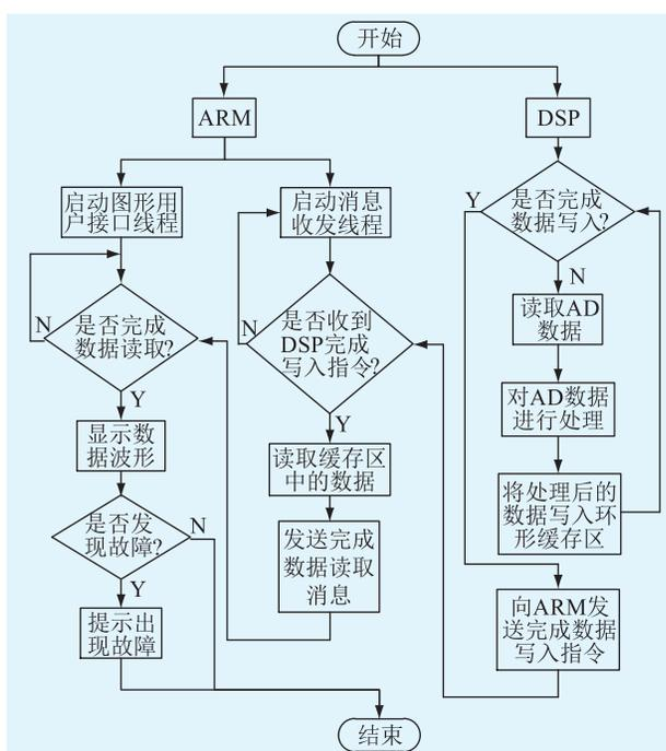
图 5 断路器在线监测软件流程
