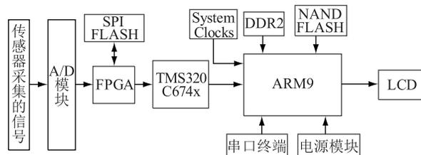
图 2 断路器在线监测系统硬件结构
