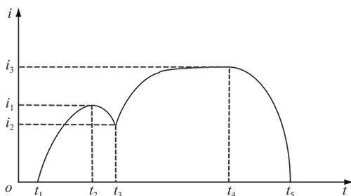
图3 断路器合闸电流波形
