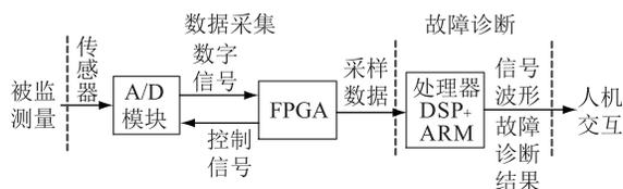
图 1 断路器在线监测系统总体架构
