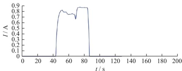
图 6 软件采集合闸电流信号波形
