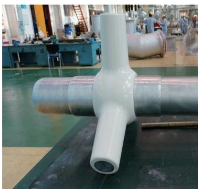
图 4 三柱式支撑绝缘子设计
