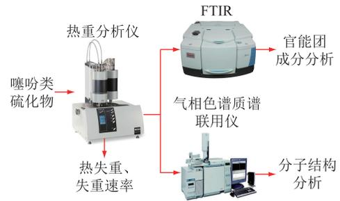
图 2 噻吩类硫化物热重试验流程
