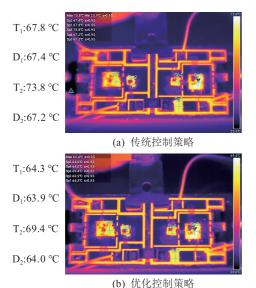
图 12 传统控制策略与优化控制策略下的 开关器件温度对比
