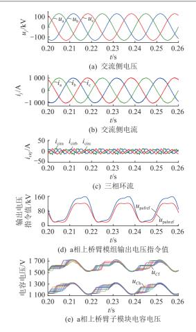
图 9 基于优化控制策略的混合型 MMC 仿真波形 Fig.9 Simulation waveforms of hybrid MMC based on optimal control strategy
