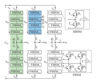
图 1 混合型 MMC 的拓扑 Fig.1 Topology of hybrid MMC
