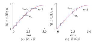
图 2 HBSM 降压前、后半桥模组的输出电压
