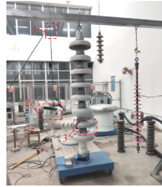
1. 滑轮 2. 电场探测装置 3. 模拟零值绝缘子
