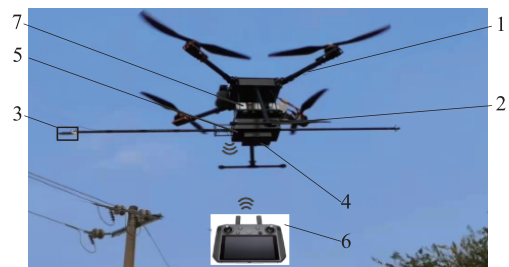
1. 无人机本体 2. 吊舱 3. 空间电场探头 4. 测距模块 5. 检测主板 6. 手持终端 7. 锂电池
