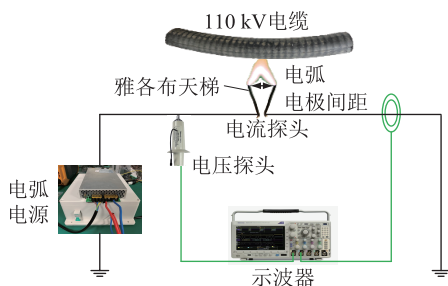
图 6 天梯电弧引燃电缆实验电路示意
