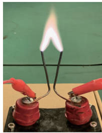
图4 天梯电弧 Fig.4 Ladder arc
