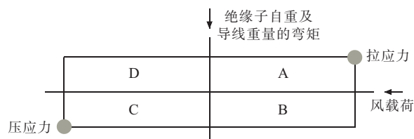
图 7 断口部位应力分析图
