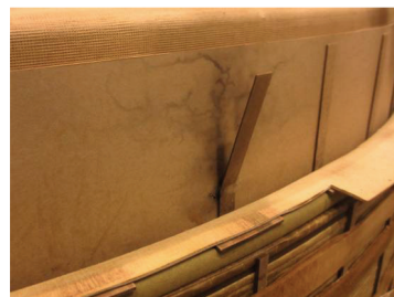
图1 调压线圈内部围屏外表面放电痕迹
