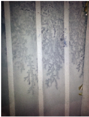
图3 阀侧绕组围屏纸板大面积树枝状放电痕迹
