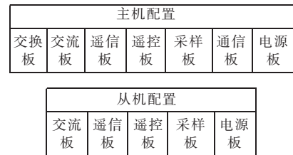
图1 集控型智能配网终端装置配置
