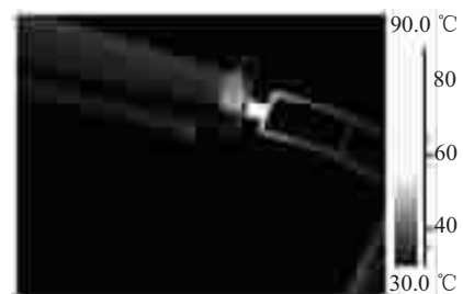
图 13 5002 开关 A 相主变侧
