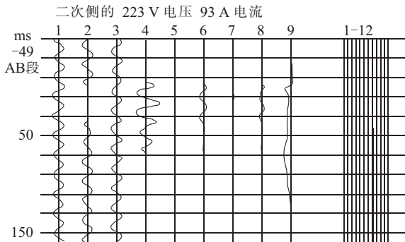
图 5 陡洼 I 线 B 相接地故障录波图
