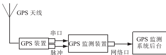
图 2 串口+分/秒脉冲方式
