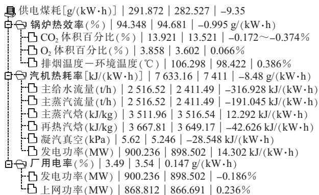
图 4 某 1 000 MW 影响因子树型结构图
