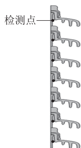
图7 绝缘子串红外检测点
