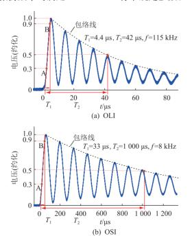
图 2 OLI 和 OSI 波形 Fig.2 Waveforms of OLI and OSI
