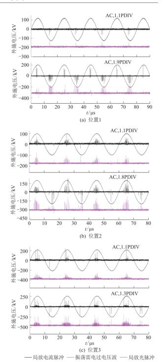
图 11 AC 电压下电流脉冲和光脉冲
