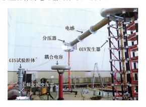
图 1 冲击电压下局部放电测试回路
