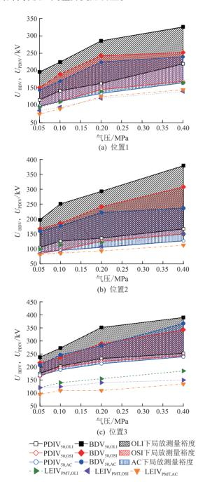
图 7 OSI、OLI 以及 AC 50 Hz 电压下的 PDIV 和 BDV Fig.7 PDIV and BDV under OLI, OSI, and AC voltages: particle at position
