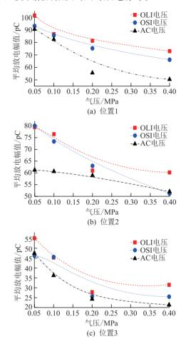
图 13 不同气压下,不同位置局部放电平均脉冲幅值 Fig.13 Average magnitudes of PDs excited at various positions
